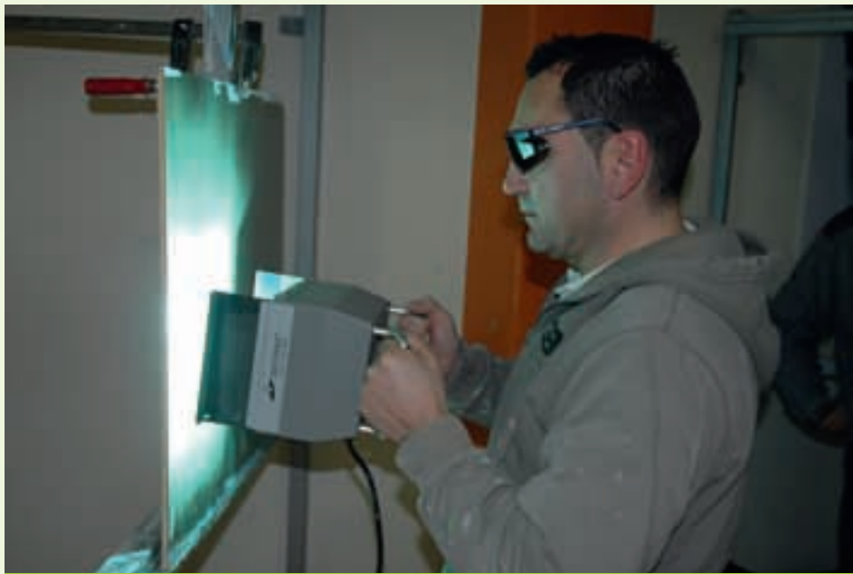
4. Dan mag men zelf aan de slag met schilderwerkdrogen via de DecoRad®-handlamp
