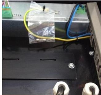
2. Entfernen Sie die angegebene Sicherungskappe und danach die Sicherung.
