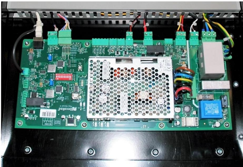
5. Entfernen Sie die 8 Inbusschrauben, mit denen die Platine befestigt ist.
