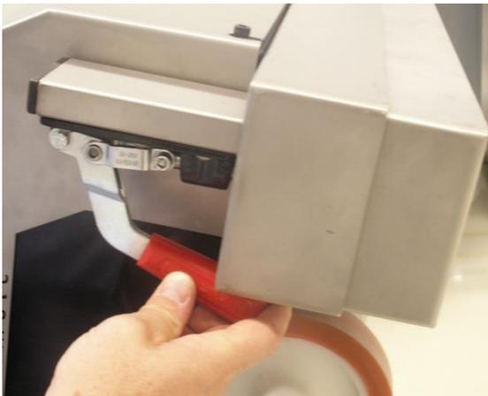
3. Lösen Sie die angegebene Inbusschraube an beiden Seiten mit einem Inbus- und einem 10er Steckschlüssel.
