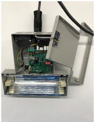
Schritt 4: Setzen Sie eine neue UV-Lampe ein, fassen Sie die Lampe dabei mit einem Tuch an. Montieren Sie die 13 Schrauben wieder zurück, jedoch nicht zu fest anziehen.
