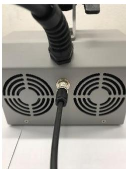
Schließen Sie das Datenkabel an den Verlängerungsgriff hinten an die Lampeneinheit an.
